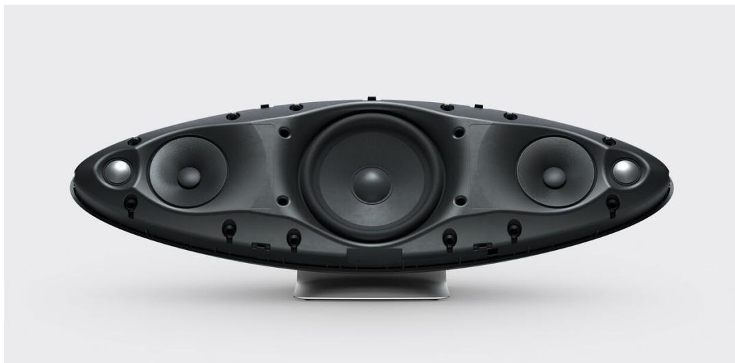
エンクロージャーの両端にマウントされているトゥイーターには、600 Series Anniversary Editionのために開発された 25mm ダブルドーム・トゥイーターと同じものが使用されています。サブウーファーから発生した振動がエンクロージャーを通して伝わり、トゥイーターの音を濁らせることがないようにエンクロージャーからデカップリングされています。これにより、ワイドで透明感が高い空間表現と極めて精度の高いサウンドを実現しています。
