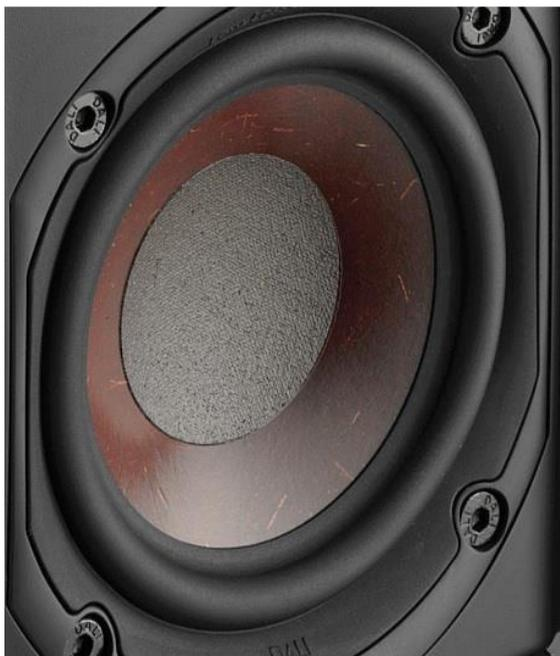
DALI 製品のミッドレンジ/ウーハー部に使用されているダイアフラムは、「ウッドファイバー・コーン」と呼ばれる微粒子パルプに木繊維（ウッドファイバー）を混合した、DALI が独クルトミュージアム社と共同開発したオリジナルの素材です。DALI では、2002 年、当時のフラッグシップ・モデル EUPHONIA でこの素材を採用して以来、以降発売されたほとんどのスピーカーにこの素材を採用しています。
